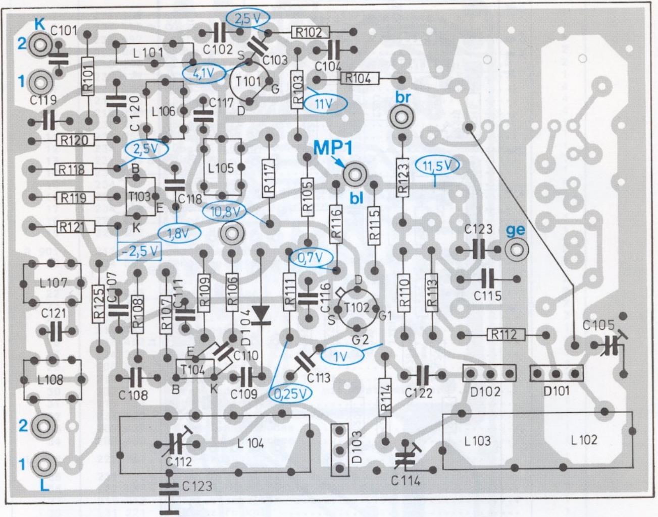
Fig. 12 Netzanschlußplatte 231 216 (Bestückungsseite)
