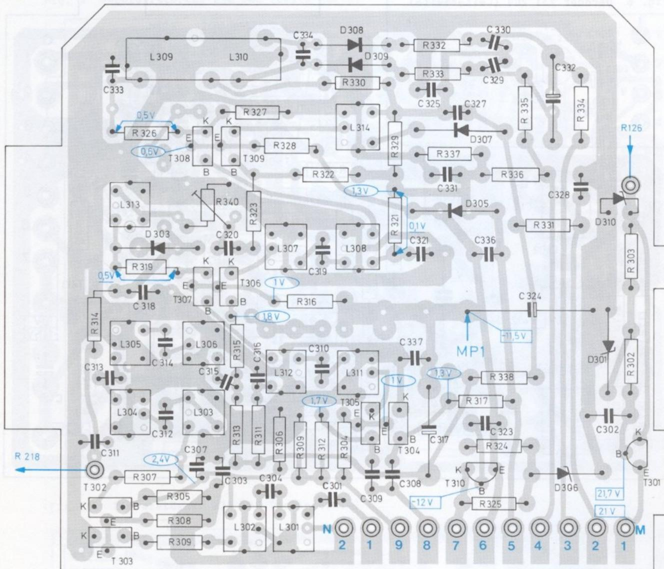
Fig. 5 Vorverstärker 227 746 (Leiterseite)
