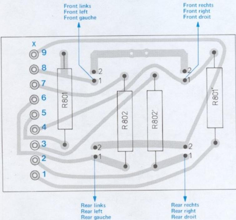
Fig. 8 Betriebsartenschalterplatte 234 473 (Leiterseite)
