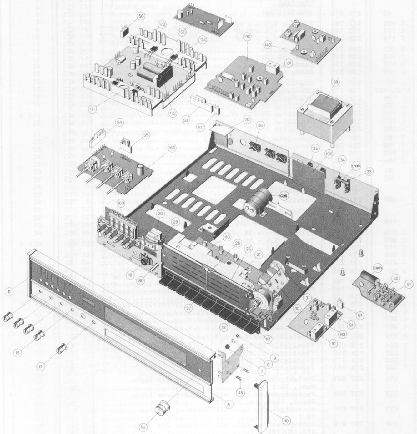
Fig. 15 Auswechseln der Tastenschieber
